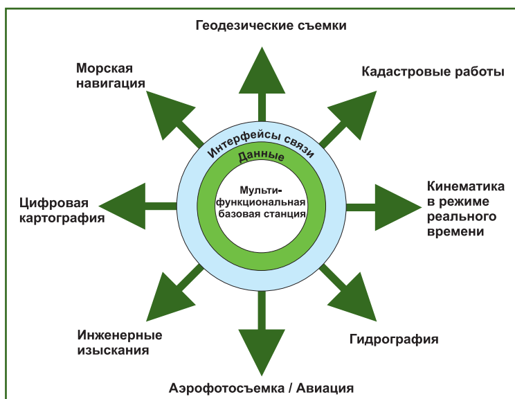
Рис. 1 Основной принцип действия базовой станции SAPOS
