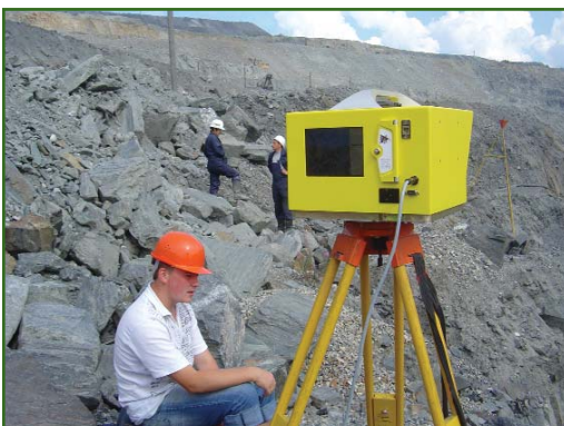
Рис. 1 Пример съемки открытой горной выработки с помощью лазерной сканирующей системы ILRS
