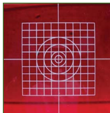
Рис. 1 Палетка прибора вертикального проектирования
