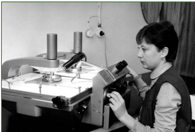
Работы по идентификации и маркировке точек на приборе PUG-4
