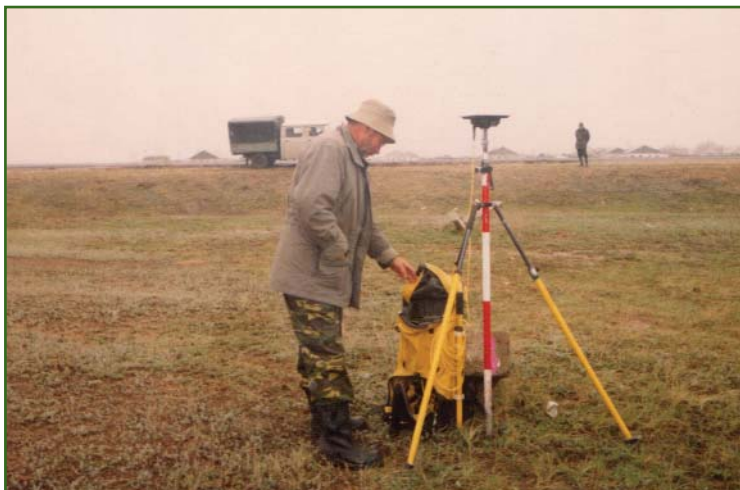
Привязка опознака с помощью приемника GPS
