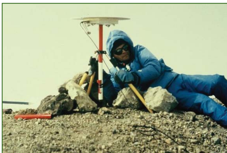
Во время измерений из-за сильного ветра местные топографы (добровольцы) вынуждены были меняться, чтобы удерживать антенну на вершине горы Рейнир в вертикальном положении (1989 г.)
