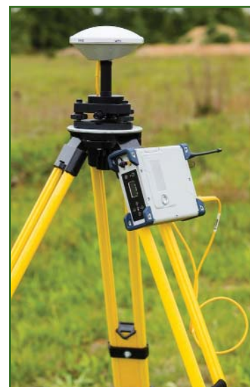
Рис. 1 Общий вид комплекта «ФАЗА 2 Геофизик-База»
