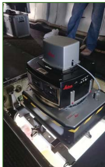
Рис. 5 Комплекс DMC III, установленный в аэросъемочном люке самолета
