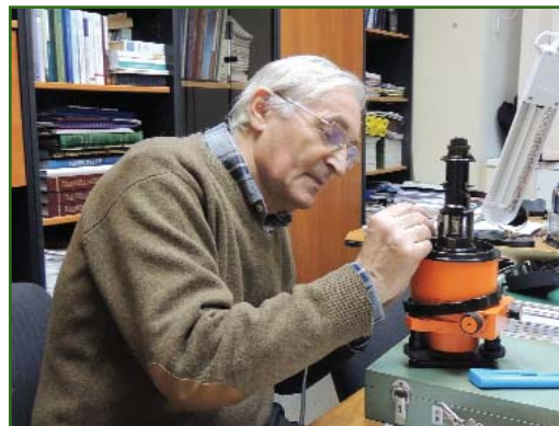
Вспоминая прошлое, ремонт маркшейдерского гирокомпаса МВГ-1 (2022 г.)
