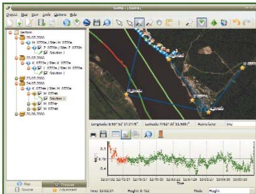
Трасу является универсальным и мощным полевым программным обеспечением для работы с мобильными полевыми компьютерами. Оно работает в операционной системе Windows Mobile и предназначено для управления процессом ГНСС-измерений в различных режимах (статика, быстрая статика, «стой-иди», накопления
