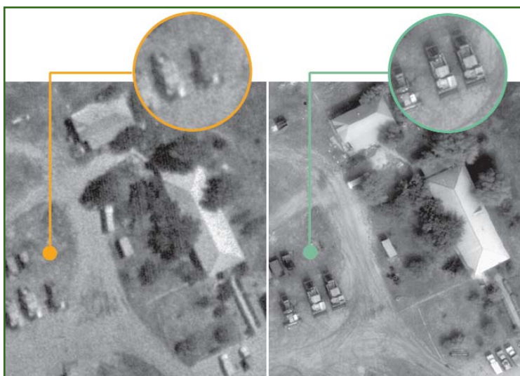
Рис. 4 Снимок, полученный АФА-140 (слева), и изображение, зарегистрированное ЦТК-140 (справа), подтверждают значительно лучшую геометрическую разрешающую способность цифровых аэросъемочных комплексов
