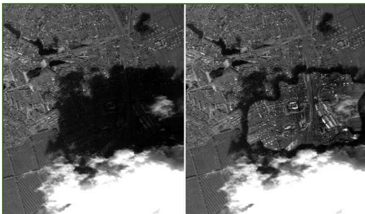
Рис. 3 Фрагменты изображений, полученных ЦТК-140, характеризующие динамический диапазон цифрового аэросъемочного комплекса
