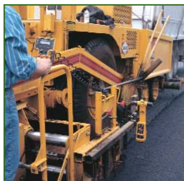
Рис. 2 Система ScreedPro, установленная на асфальтоукладчике
