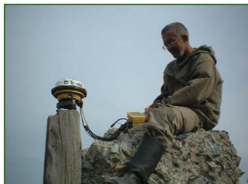
Рис. 3 Измерение координат опорной точки
