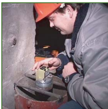
Рис. 3 Измерение расстояния дальномером DI2002 на элеваторе
