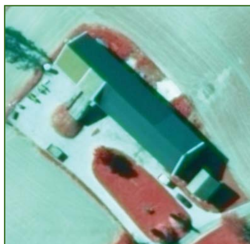
Рис. 6 Несовпадения цветов (UltraCam, спектрозональная съемка)
