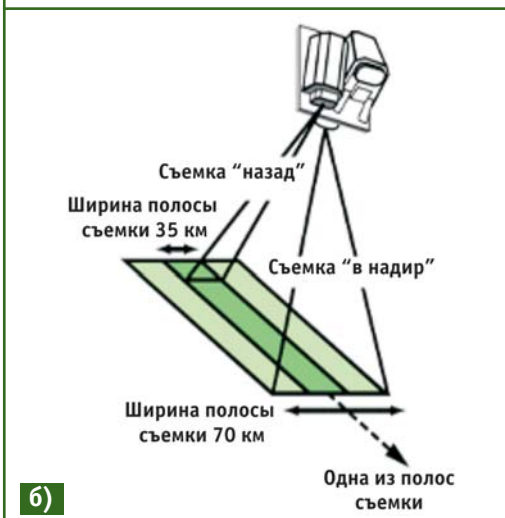
Рис. 2 Режимы съемки стереокамеры PRISM: а) «нормально»; б) «наблюдение»
