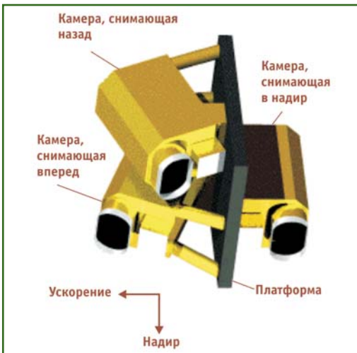
Рис. 1 Расположение съемочных камер стереокамеры PRISM
