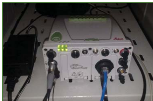
Рис. 3 Приемник ГНСС референционной станции
