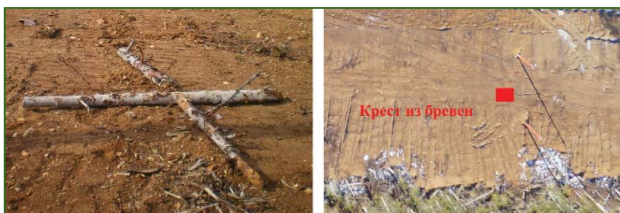
Рис. 2 Точка ПВП вид на земле (слева) и на снимке при высоте аэросъемки 150 м (справа)
