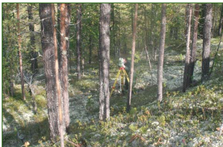
Рис. 5 Работа с тахеометром Leica FlexLine TS06
