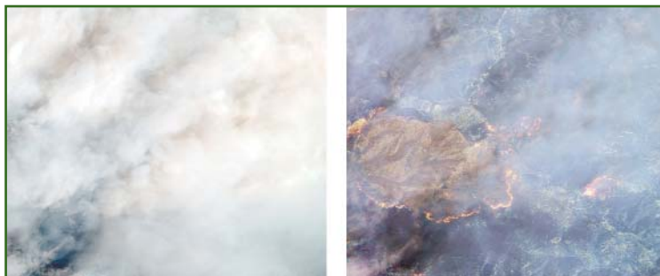
Рис. 2 Фрагмент снимка WorldView-3 с изображением лесного пожара: слева — в натуральных цветах, справа — синтез коротковолновых ИК-каналов (SWIR)
