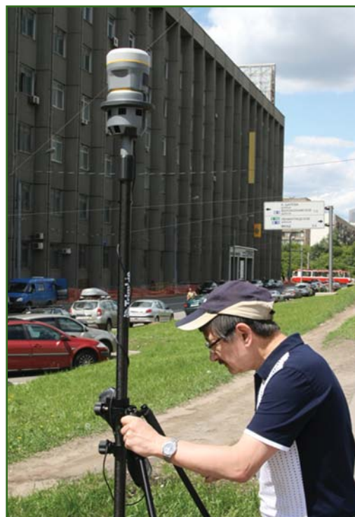
Рис. 2 Работа с системой V10 и приемником ГНСС R10
