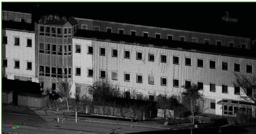
Облако точек одного из цехов предприятия в Дандерюде после сканирования и обработки в программе ТВС. Фасад здания отсканирован в грубом режиме, а две области (слева и справа внизу) — более детально ( www.xyht.com )
