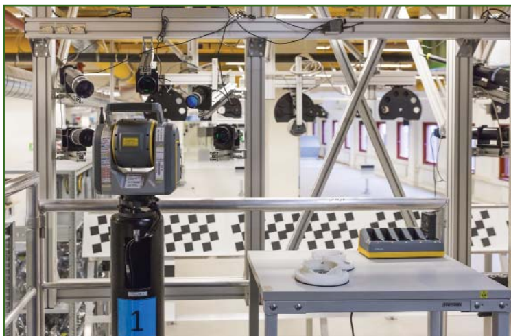
Испытательный стенд в цеху с коллимационными целями и марками для исследования устройств измерения расстояний и фотокамер ( www.xyht.com )
