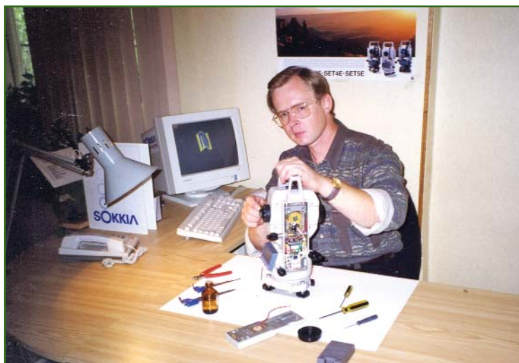
С.П. Шелагин проводит ремонт электронного тахеометра серии SET фирмы SOKKIA
