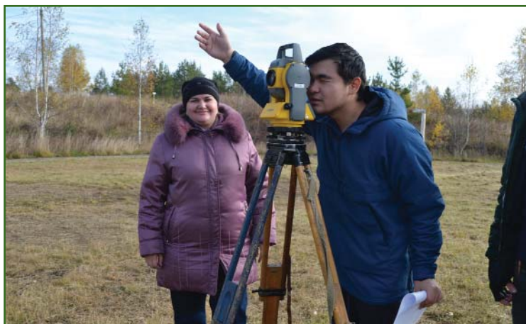
Рис. 1 Вынос в натуру точек по известным координатам
