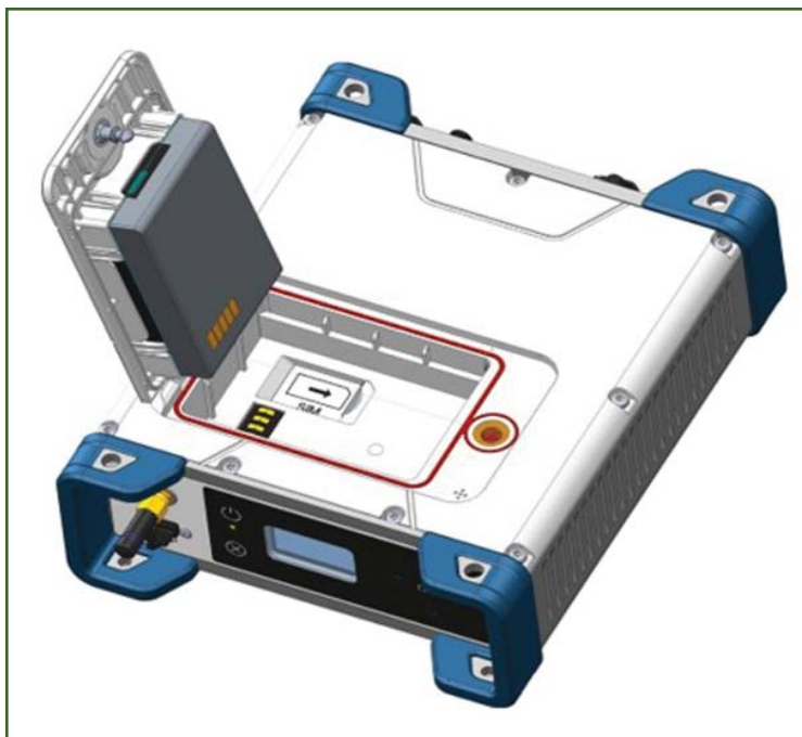
Рис. 3 Замена батареи в ГНСС-приемнике ФАЗА 2
