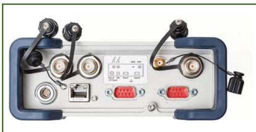
Рис. 2 Общий вид задней панели ГНСС-приемника ФАЗА 2 с разъемами
