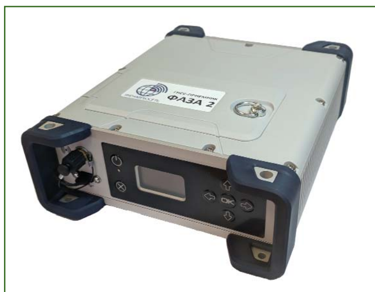
Рис. 1 Общий вид ГНСС-приемника ФАЗА 2
