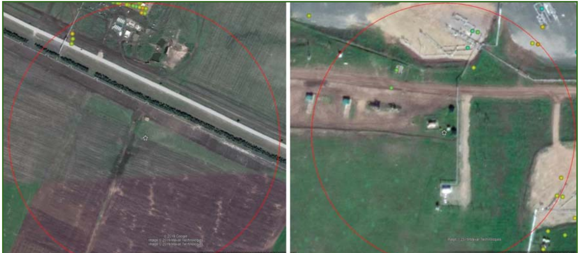
Рис. 5 В радиусе 500 м от станции ГНСС 12 устойчивых отражателей (слева); в радиусе 100 м от станции ГНСС 10 устойчивых отражателей
