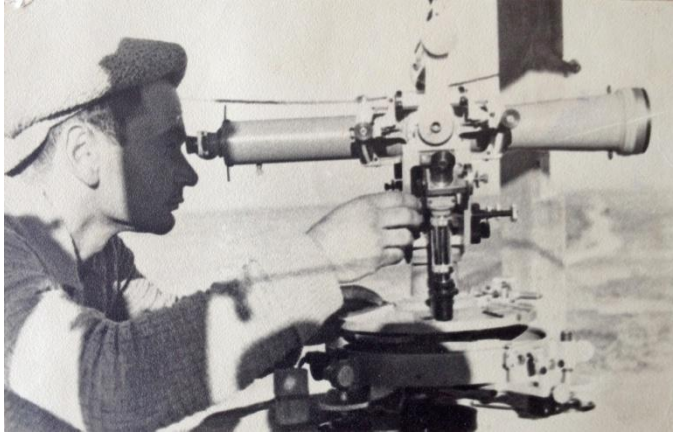
Г.П. Райзман выполняет измерения при проложении триангуляции 2 класса. Полуостров Бузачи (Западный Казахстан), 5.10.1956 г. Фото А.П. Райзмана
