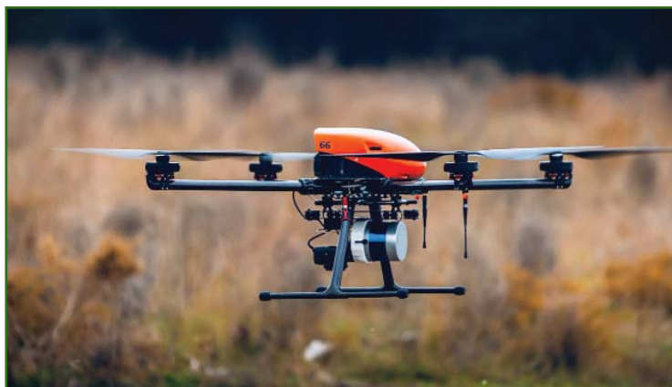
Рис. 1 Общий вид системы «Геоскан 401 Лидар»
