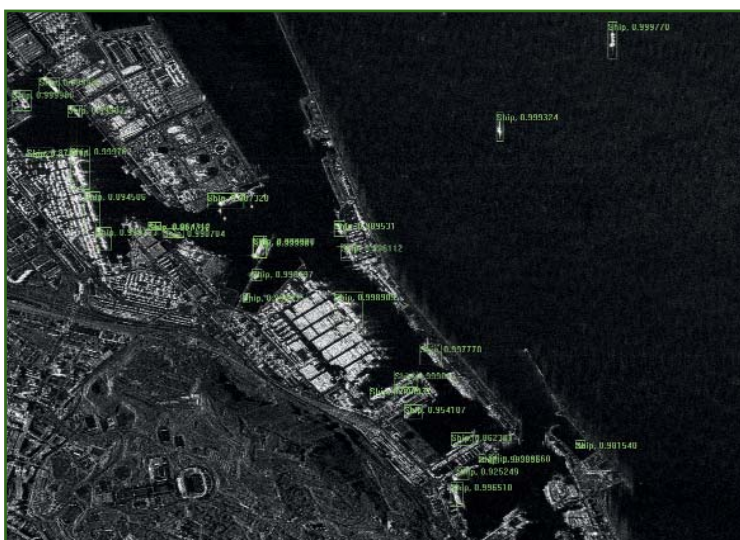
Рис. 5 Пример мониторинга акватории порта на предмет наличия кораблей (фрагмент снимка КА TerraSAR-X, г. Барселона, Испания)
