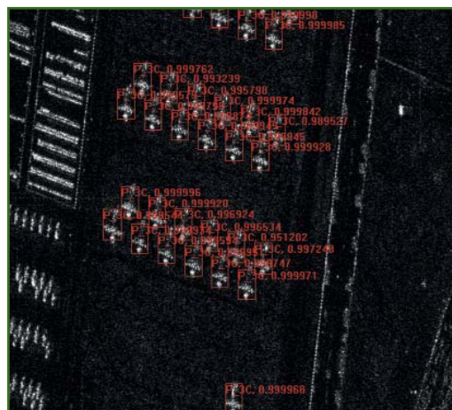
Рис. 4 Пример обнаружения и классификации самолетов класса Р-3С (фрагмент снимка КА «Кондор-Э», авиабаза Дэвис-Монтен, г. Тусон, США)
