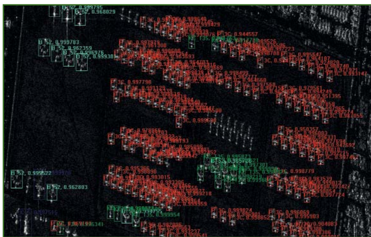
Рис. 3 Пример обнаружения и классификации самолетов на РЛИ (фрагмент снимка КА «Кондор-Э», авиабаза Дэвис-Монтен, г. Тусон, США)
