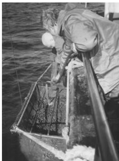
Рис.2 Отмывка пробы ЖМК через сито
