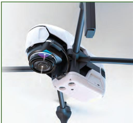
В рамках развития серии БАС «Геоскан Gemini» в 2025 г. планируется внедрение новой камеры Geoscan PF1B. Разработка успешно прошла полный цикл квалификационных испытаний и подтвердила соответствие техническим требованиям. В ближайшее время камера будет серийно устанавливаться на обновленные комплектации БВС.
